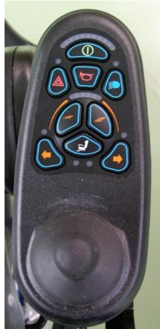
Mando VR2 para 2 actuadores eléctricos y luces
